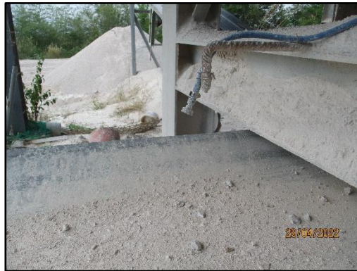
ภาพที่ 2.15 การติดตั้งระบบสเปรย์น้ำบริเวณจุดกำเนิดฝุ่น
